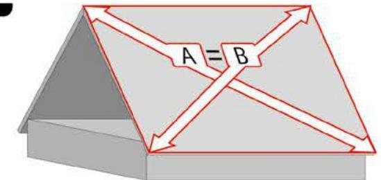
Zistíme, či je strecha rovnobežná. Malé rozdiely v rozmeroch sa dajú vyrovnáť pomocou štítovej dosky. Pri väčších rozdieloch vymeníme poškodené časti strechy.
