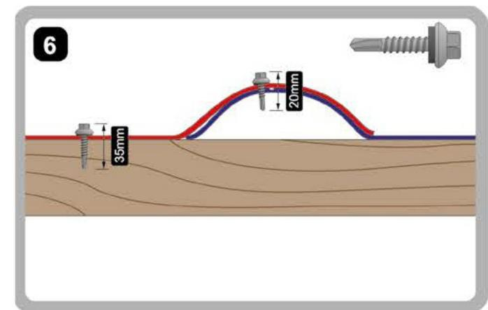
Krytinu skrutkujeme do lát skrutkami dĺžky 35 mm. Priemerná spotreba skrutek je 5-8 ks/1m<sup>2</sup>. Aby boli tabule pevne spojené, použijeme kratšie skrutky, napr. 20 mm.
