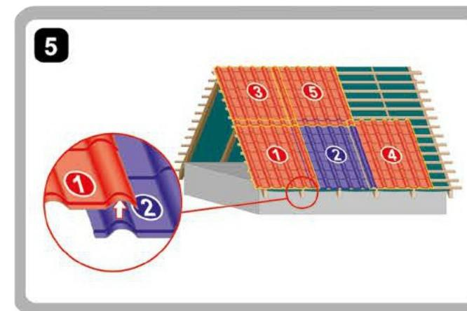
Pred montážou krytiny namontujeme závetrové lišty. Krytinu začíname montovať zľava (netýka sa profilov simetrick). Presné poradie montáže jednotlivých kusov je znázornené na obrázku.
