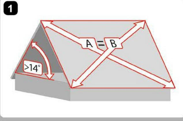
Zistíme, či je strecha rovnobežná. Malé rozdiely v rozmeroch sa dajú vyrovnáť pomocou štítovej dosky. Pri väčších rozdieloch je nutné vymeniť poškodené časti strechy.
