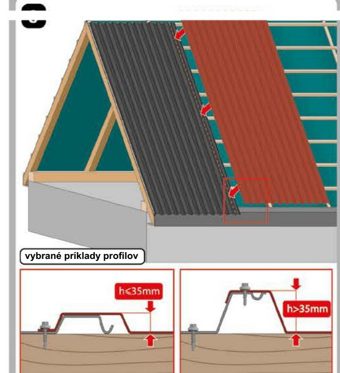
Pri montáži ďalšej tabule nesmieme zabudnúť na preklad. V prípade profilu väčšieho ako 35 mm spojíme dodatočne aj na "hornej vlne", cca 60 cm od seba pozdĺž plechu.
